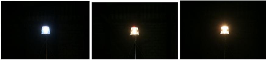
von links nach rechts umgebaute LED, 10 Watt Original und eine 21 Watt KFZ Lampe
