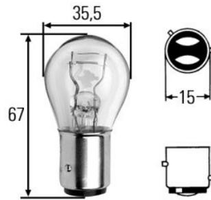
So sieht eine KFZ Lampe mit BA 15 aus. Unten siehst Du zwei ovale Kontakte. Eine Kontaktpol ist für 21 Watt Bremslicht und ein Kontaktpol ist für 10 Watt Schlusslicht. Der Minuspol geht über den Sockel wo die zwei Nöppchen sind.
