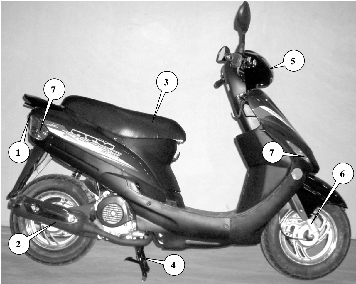
1.Rückleuchteinheit, 2. Auspuff, 3. Sitzbank, 4. Hauptständer 5. Scheinwerfer, 6. Telegabel, 7.Blinker
